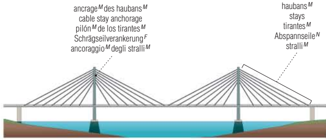
haubans M en éventail M fan cable stays tirantes M en abanico M Zügelgurte N stralli M a ventaglio M
